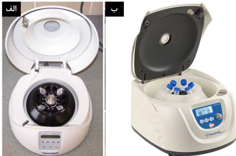
شکل ۲۳-۲. الف) یک سانتریفیوژ با روتور مناسب لوله‌های اپندورف که در آن لوله‌ها به صورت متقارن چیده شده‌اند؛ ب) سانتریفیوژ با روتور مناسب لوله‌های فالكون ۱۵ میلی‌لیتری
